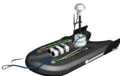
Figura 2 – Esquemático do Sistema M9 com transmissão por rádio (neste trabalho não foi utilizada antena GPS)
