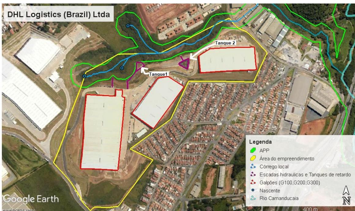
Figura 4. Localização real dos tanques de retardo de águas pluviais em divergência com o projeto de drenagem aprovado pela SOU. Fonte: Google Earth Pro (2023) e Geopixel (jan/2024).
