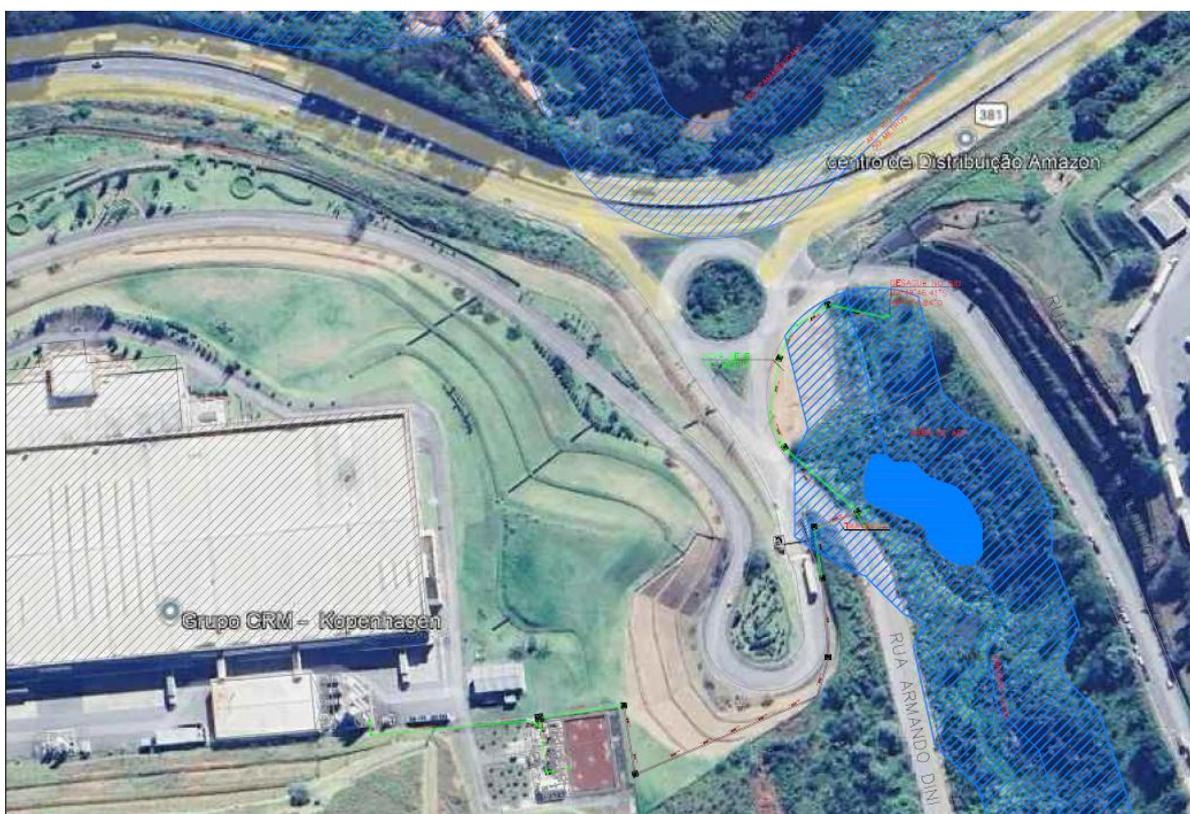
**Figura 3.** Traçado do emissário de efluente líquido tratado, com destaque para os cursos hídricos e respectivas áreas de preservação permanente (APP). Fonte: PIAS
