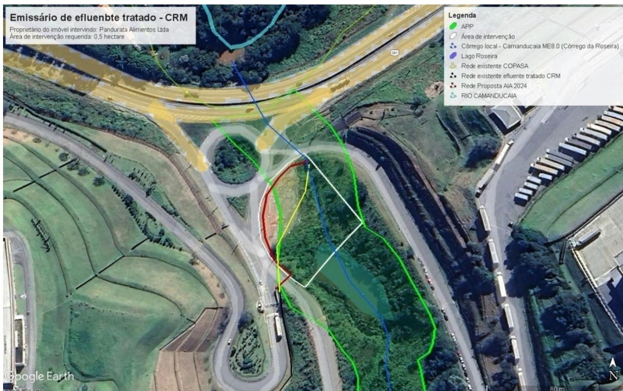
**Figura 4.** Traçado do emissário a implantar, com destaque para o trecho de intervenção em área de preservação permanente (APP). Fonte: Google Earth Pro (2023).
