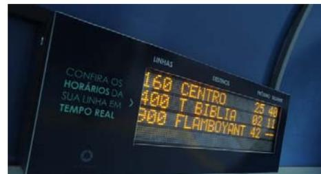
Figura 1: Exemplo de Painel de Mensagens Variáveis instalado em ponto de parada (Goiânia)
