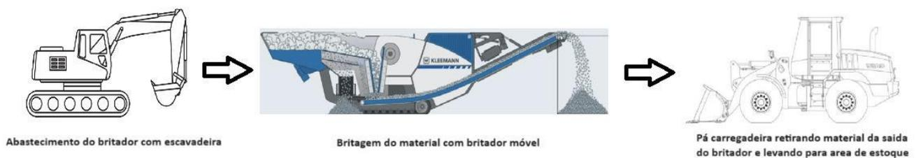
**Figura 2.** Fluxograma do processo de britagem móvel.
