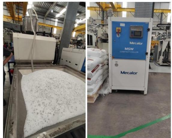
Figura 4 e 5. Sistema de abastecimento de matéria-prima e refrigerador das injetoras.
