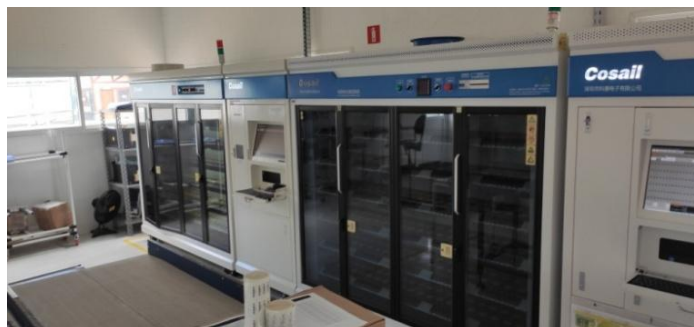
Figura 32. Equipamento de testes de resistencia (PTH).
