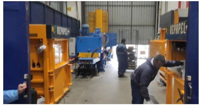
Figura 13. Doca de gestão e destinação dos recicláveis (papel, papelão, plásticos) e detalhe das prensas instaladas.
