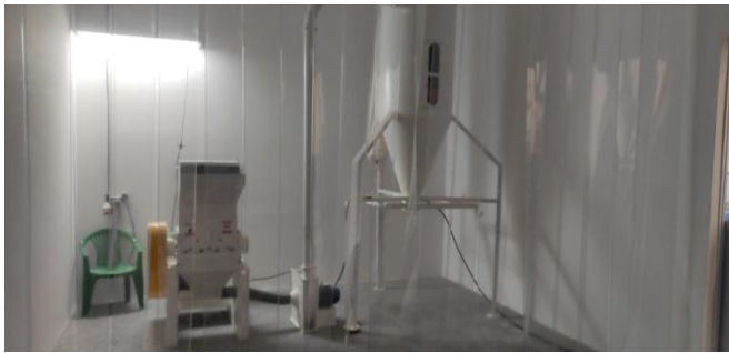
Figura 4. Detalhe do silo e moedor na Sala de reaproveitamento da matéria prima
