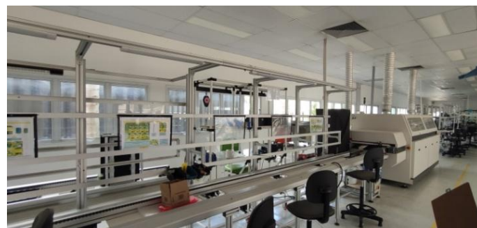
Figura 31. Linha de montagem de componentes da placa de rede na sala denominada PTH do antigo laticínio.
