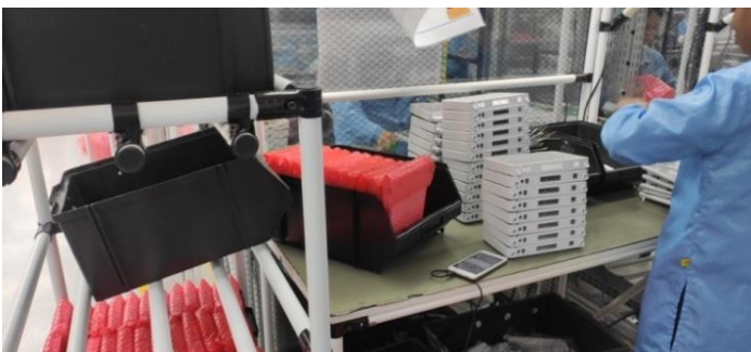
Figura 29. Linha de montagem de roteadores em “sala de proteção eletrostática”, área denominada ZTE do antigo laticínio.
