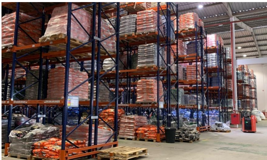
Figura 4. Estantes porta paletes – 10 ruas de estocagem em 5 níveis (solo/picking + 4 aéreos)
