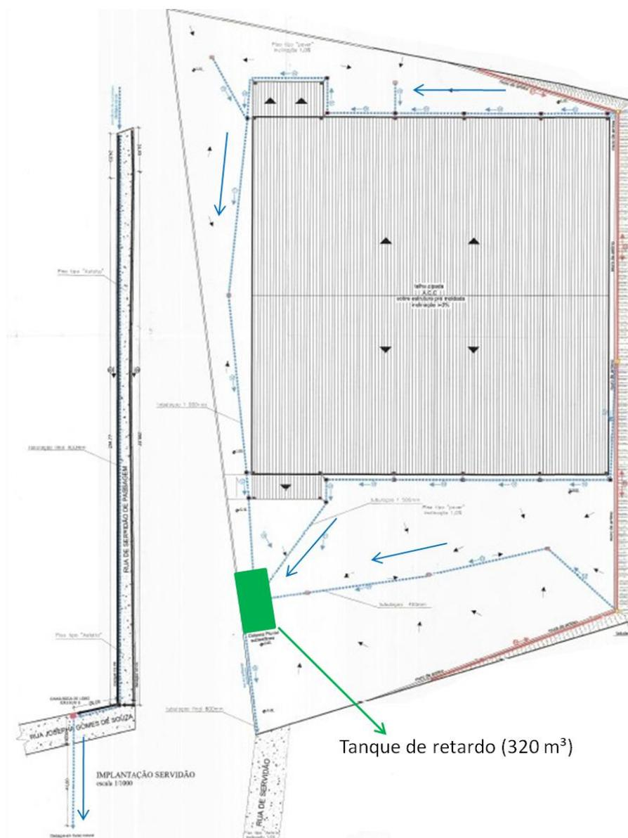
Figura 2. Projeto de drenagem de águas pluviais (dentro dos limites do terreno).
