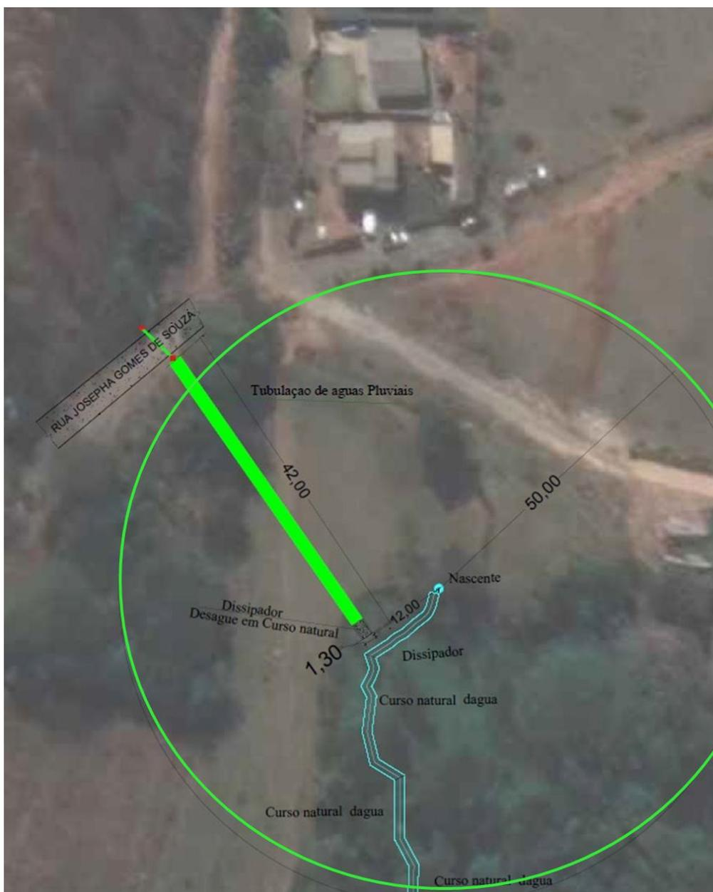
**Figura 8. Localização da intervenção em área de preservação permanente – APP para fins de lançamento de águas pluviais.** Fonte: Projeto de Drenagem de Águas Pluviais (Fernando Rogério Alves)
