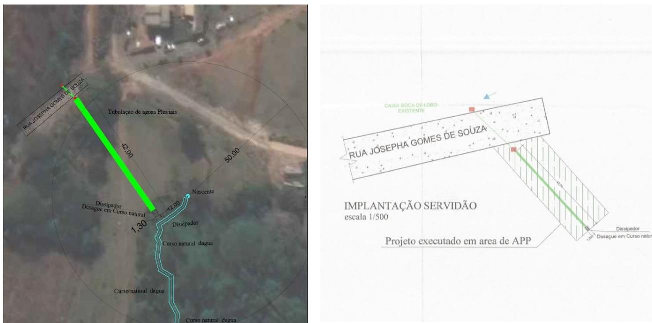
Figura 3. Projeto de drenagem de águas pluviais (lançamento fora dos limites do terreno).
