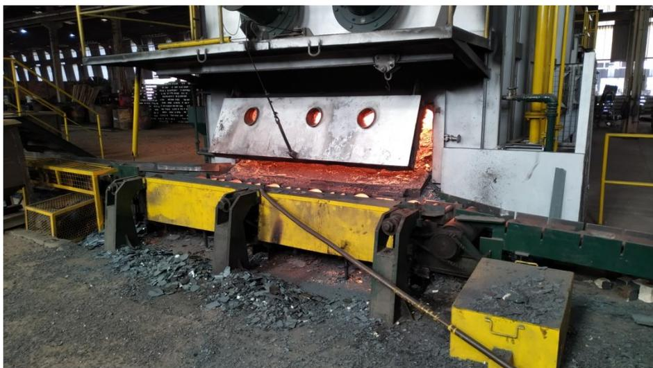
**Figura 8.** Forno a GLP para aquecimento dos lingotes.
