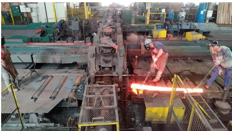
**Figura 9.** Vista do processo de conformação dos laminados.
