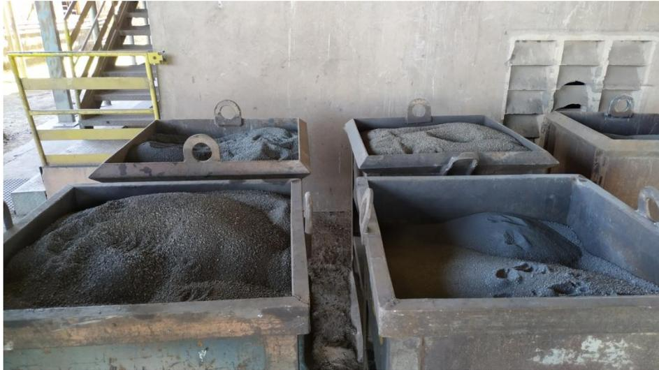
**Figura 4.** Armazenamento de granalhas de aço.
