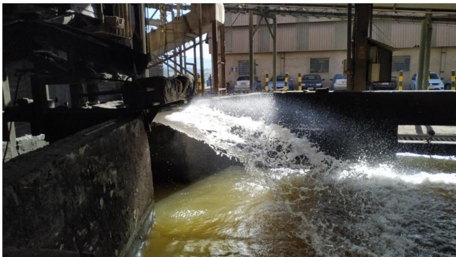
**Figura 2.** Vista da piscina de água com cascata para conformação das granalhas de aço.
