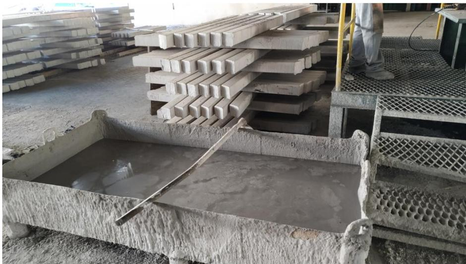
**Figura 7.** Bandeja para pintura dos lingotes de aço/ferro para inserção no forno.
