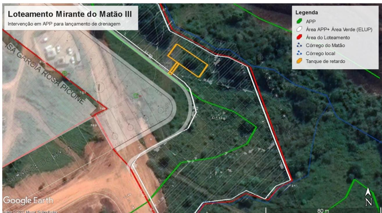
Figura 6. Intervenção em APP para instalação do tanque de retardo de Drenagem. Fonte: Google Earth (2021)
