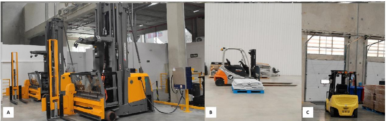
Figura 9. Empilhadeiras e ponto de recarga (A) Empilhadeira Trilateral para movimentação nos corredores e Ponto de Recarga e (B) e (C) para movimentação interna de produtos.
