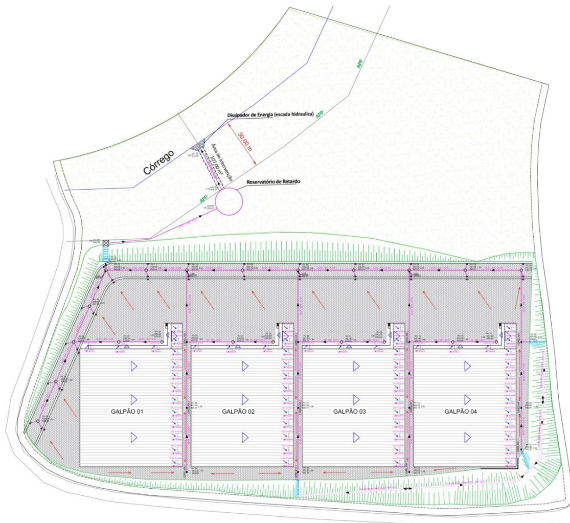
Figura 3. Projeto de drenagem de águas pluviais
