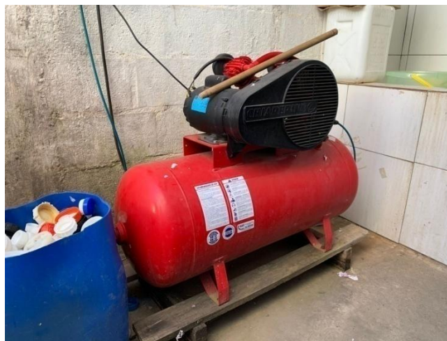
Figura 15. Compressor Chiaperini desativado.
