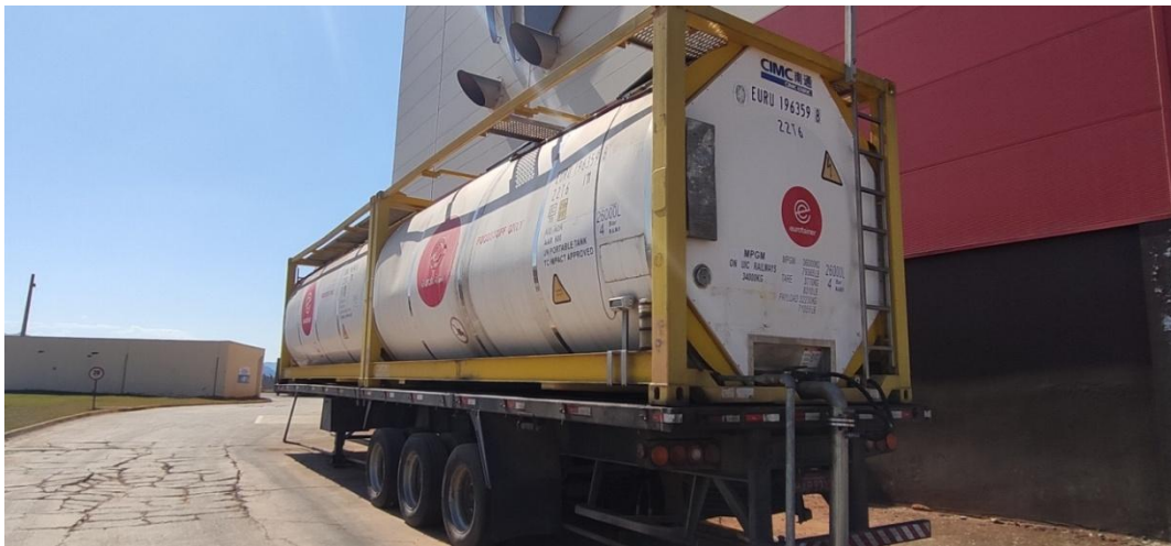
Figura 4. Tanque externo para armazenamento de gorduras.
