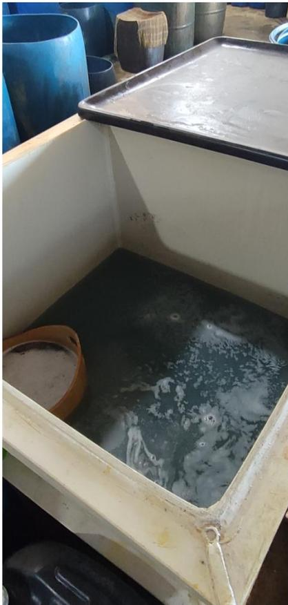
Figura 7. Tanque para banho ácido (Decapante).
