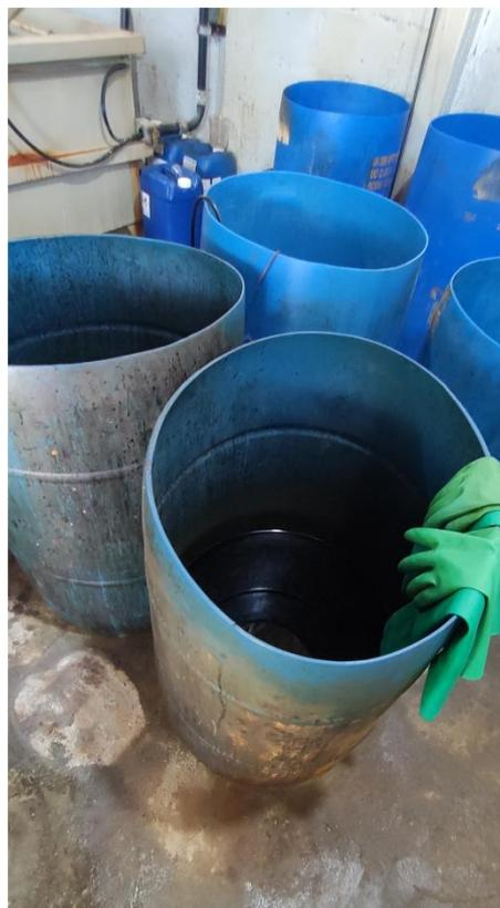
Figura 9. Tanques para passivação.
