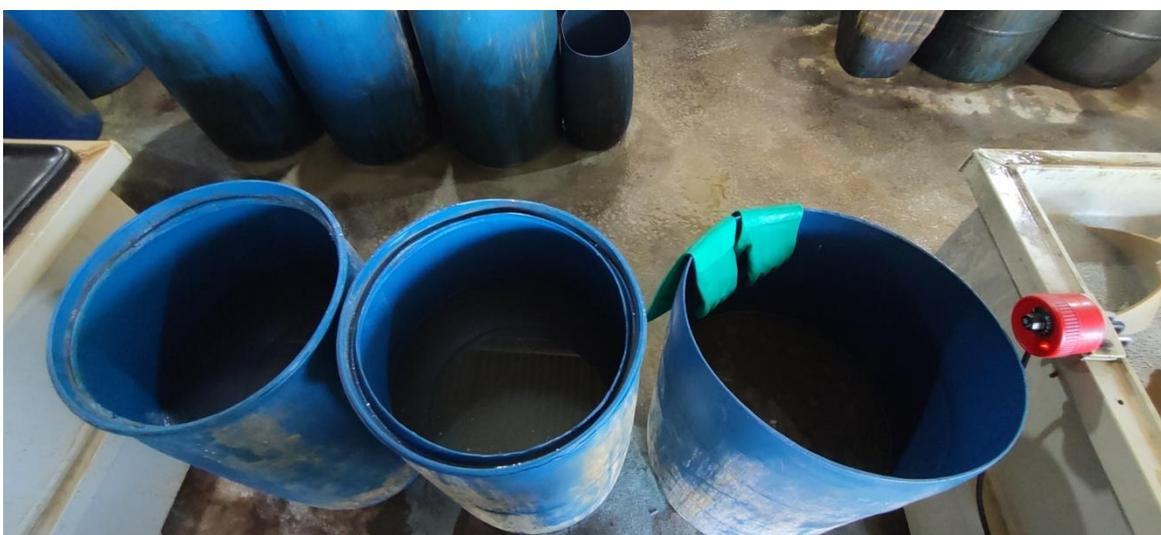
Figura 6. Tanques de lavagem do processo de desengraxe de peças.
