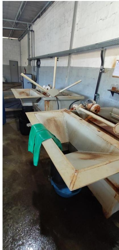
Figura 8. Tanques Rotativos para zincagem.
