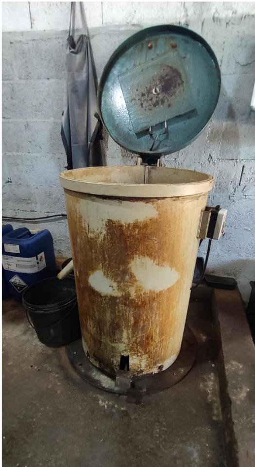
**Figura 10. Centrifuga utilizada para secagem do material.**
