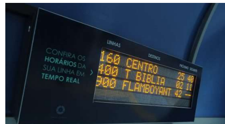
Figura 24: Exemplo de Paineis de Mensagens Variáveis instalado em ponto de parada (Goiânia)
