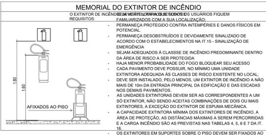
**PROJETO TÉCNICO SIMPLIFICADO DE PROTEÇÃO E COMBATE A INCÊNDIO** FOLHA 1/1
