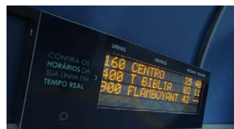
Figura 35: Exemplo de Painel de Mensagens Variáveis instalado em ponto de parada (Goiânia)
